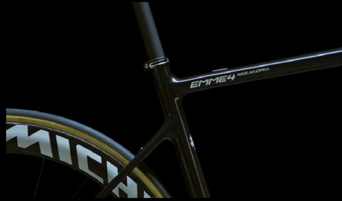
La tecnologia di produzione del telaio MONOLITH permette di avere attraverso la particolare configurazione dello stampo, un unico vero monoscocca in totale assenza di punti di giunzione tra il quadrilatero anteriore e il carro posteriore. Grazie alla omogeneità della distribuzione delle fibre di carbonio su tutta la lunghezza del telaio, l'elasticità e la reattività sono spinte ai massimi livelli, mentre il peso viene alleggerito.
